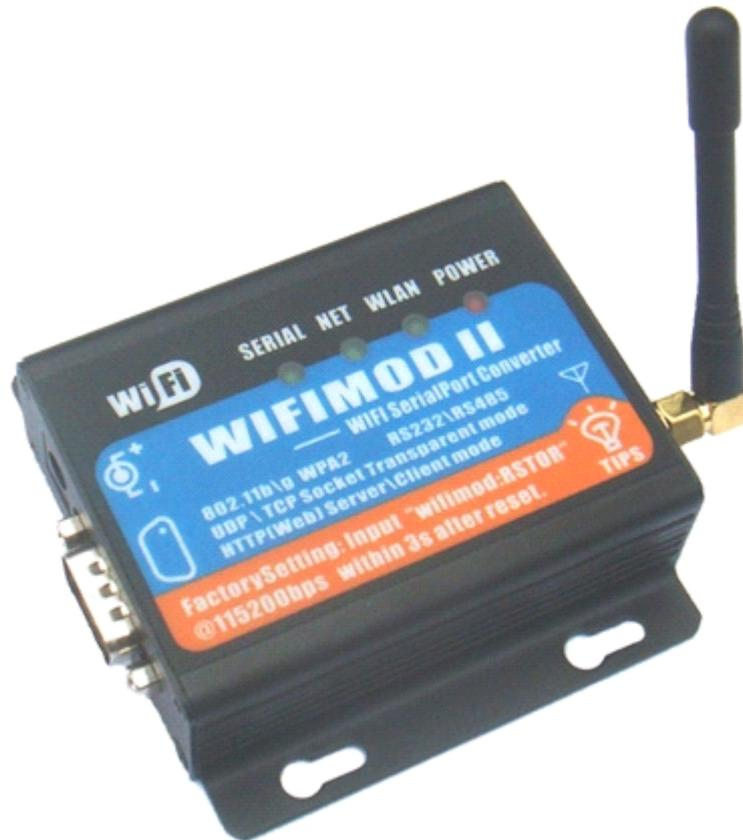
Wi-Fi 串口服务器是一款用来将串口数据和 WIFI 网络数据互相转换和传输的设备，可以工作与 TCP Server, TCP Client 和 UDP 模式实现透明传输，也可以工作在 Sweb 模式通过浏览器网页实现复杂交互，使用简单，工作可靠。
